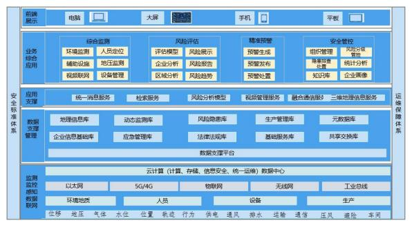
非煤矿山安全生产风险监测预警系统采用云化、微服务技术路线,主要由监测监控感知数据联网、数据支撑管理、应用支撑、综合业务应用用等组成。
