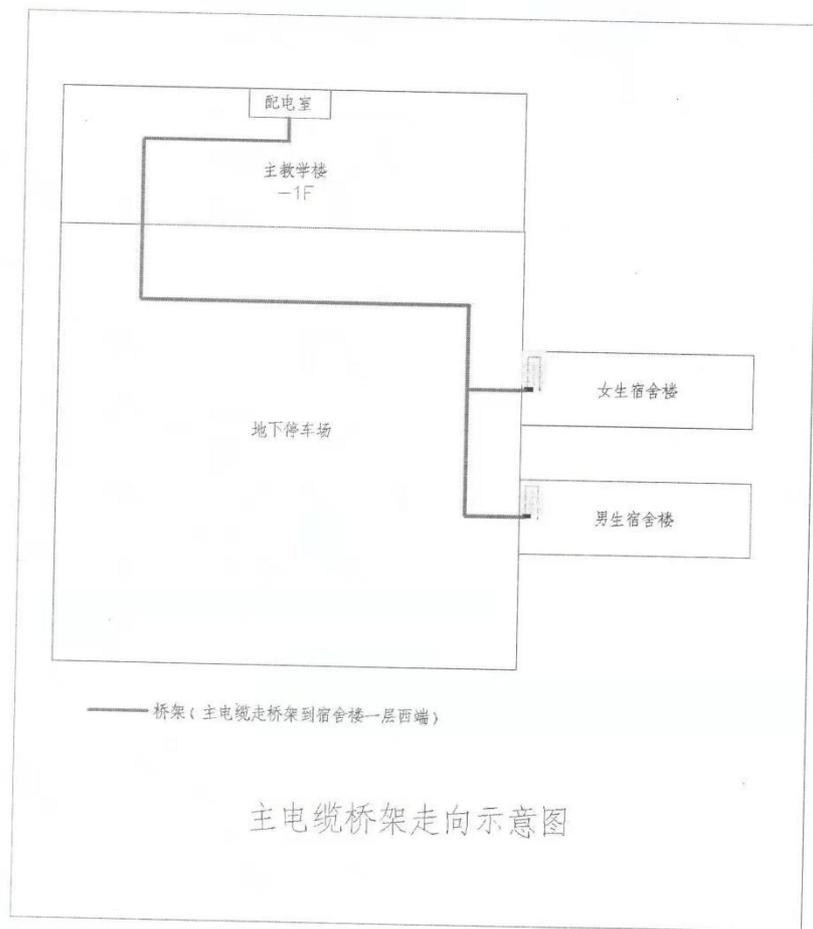
主电缆桥架走向示意图
