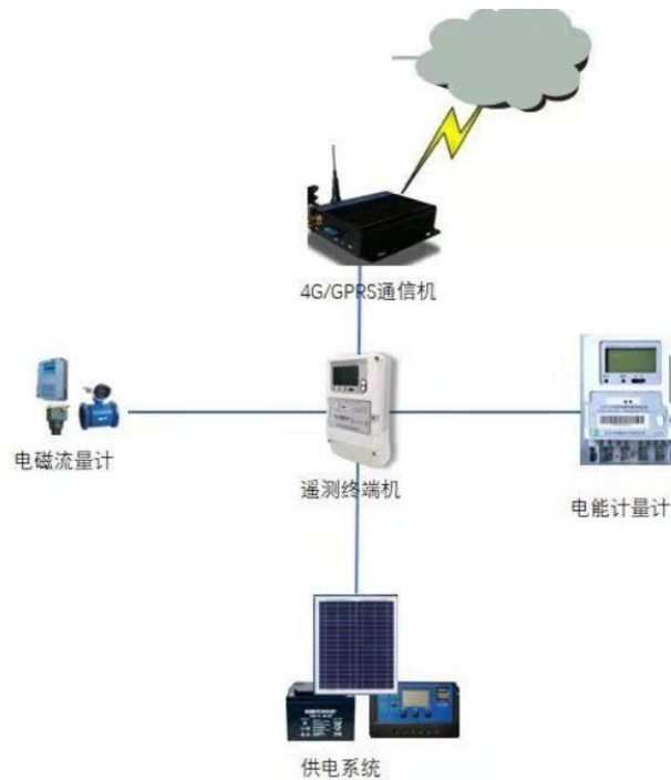
图 以电折水自动监测站结构图
