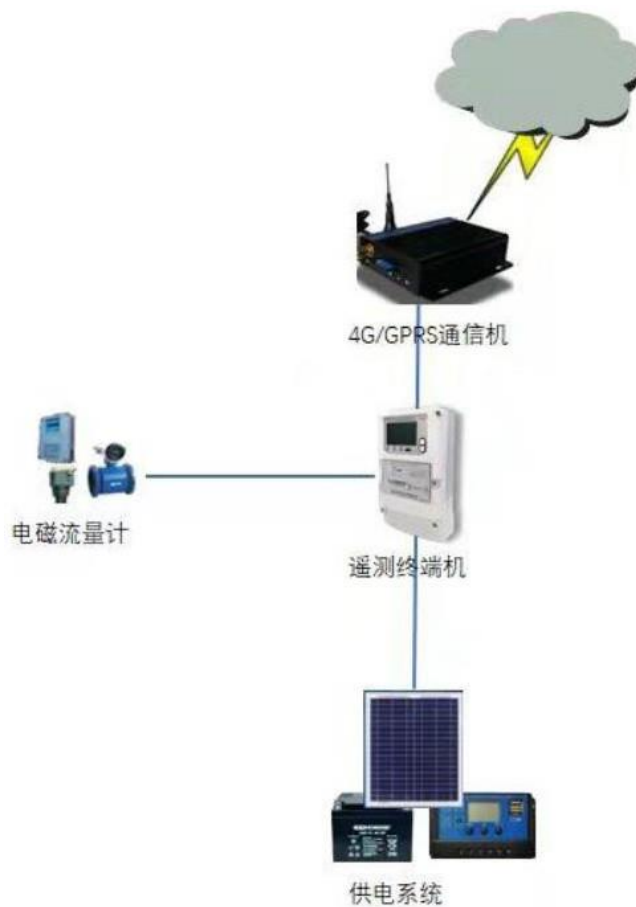
图 管道型水量自动监测站结构图
