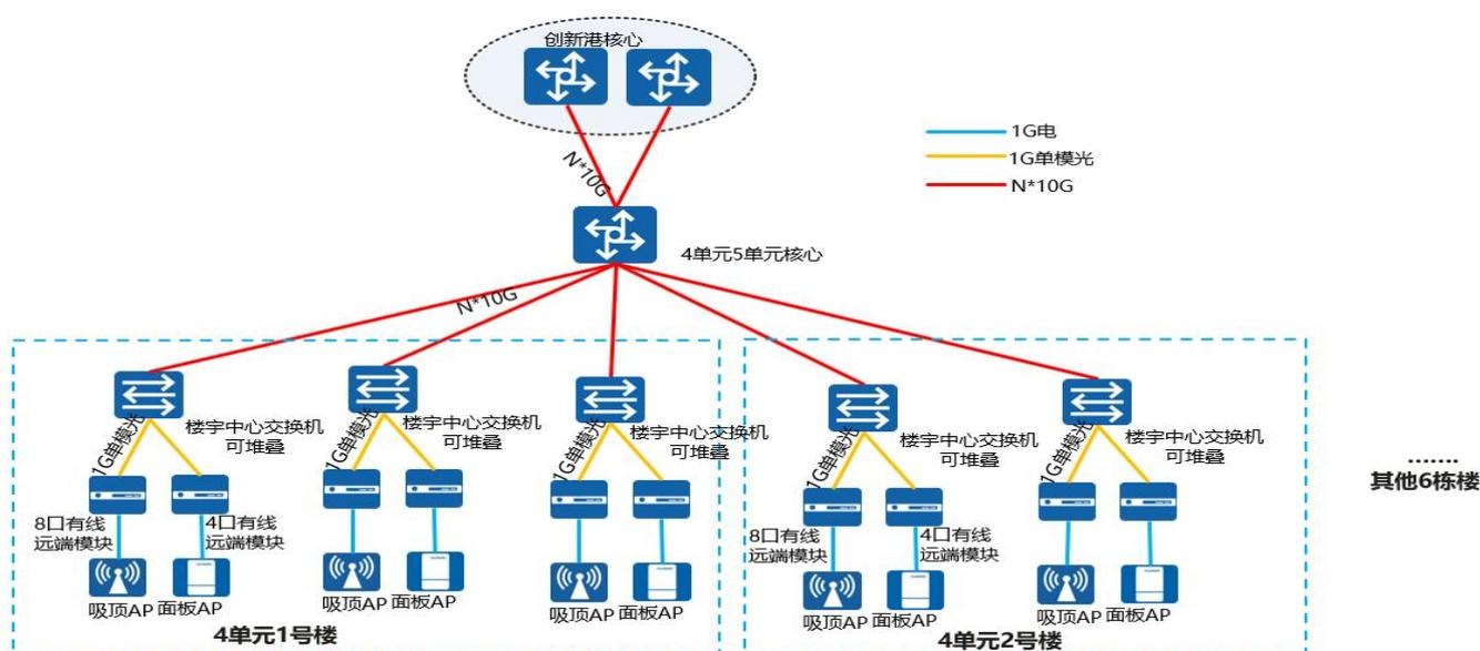
楼宇基础网络由楼宇中心交换机、房间内的有线远端模块、AP 组成。
