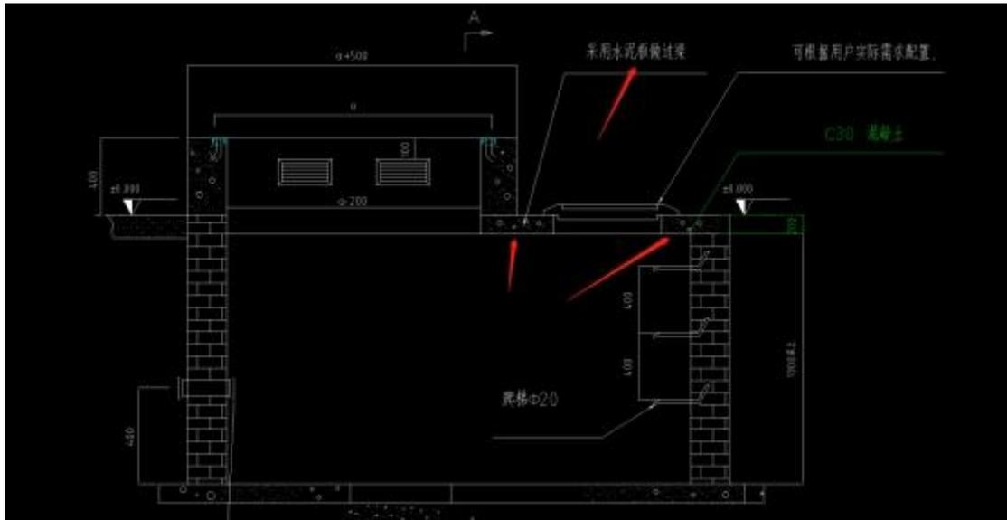
回复:盖板采用 c30 混凝土浇筑,
