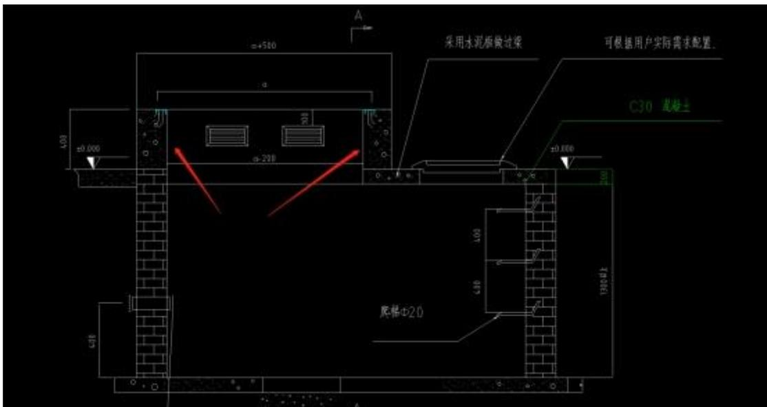
回复:上部侧墙是砖墙，用普通红砖砌筑，墙厚 240mm，砌筑砂浆 1:2 的水泥砂浆。
