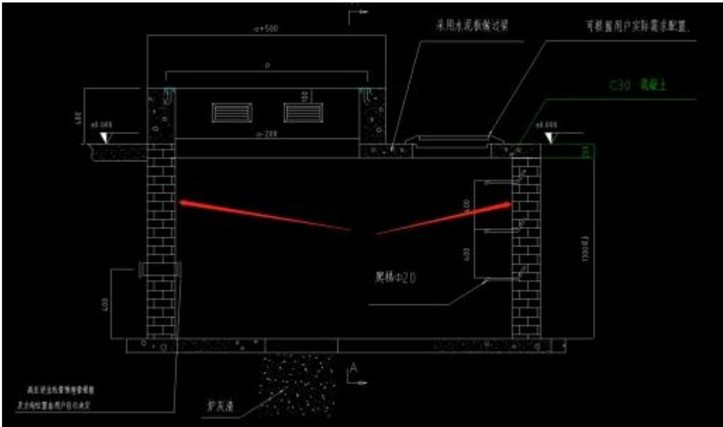
侧墙用普通红砖砌筑，墙厚 240mm，砌筑砂浆为 1:2 的水泥砂浆。
