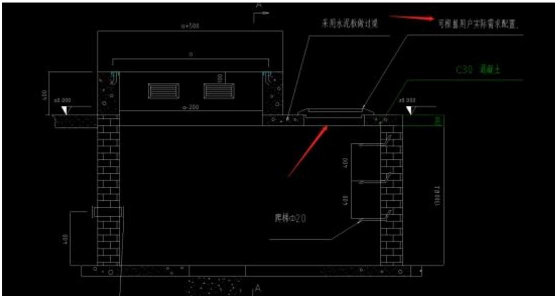
回复:盖板采用直径 700mm 的球墨铸铁圆形井盖。
