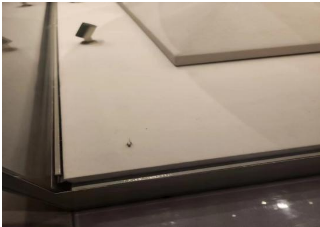
展柜柜体、玻璃变形严重 影响密封性能
