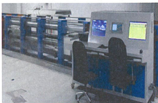
(b) 2000kN 静力拉伸实验系统
