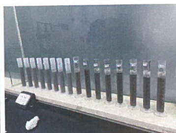
凝结时间测定
