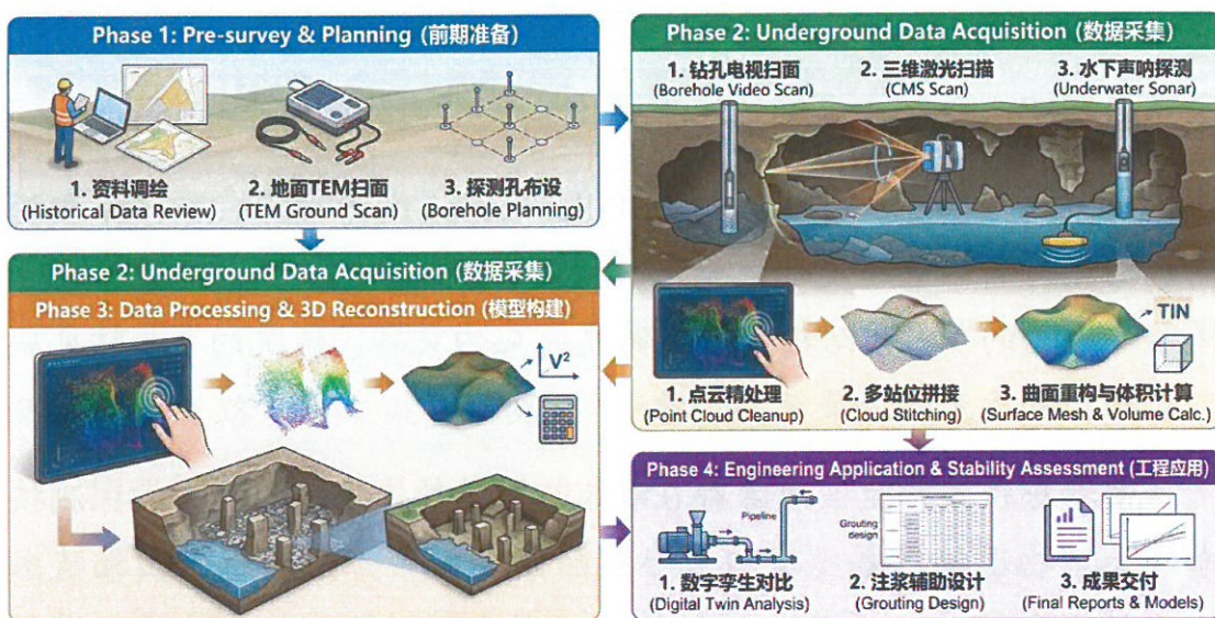
图 3.11 采空区探测与三维重建方案
