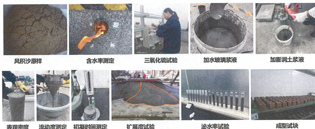
图 3.12 注浆液制备流程
