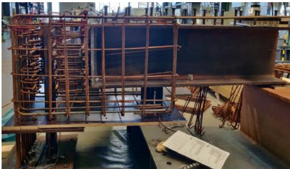
图 2.2 带 CL 组合连接件的无缝桥试验
