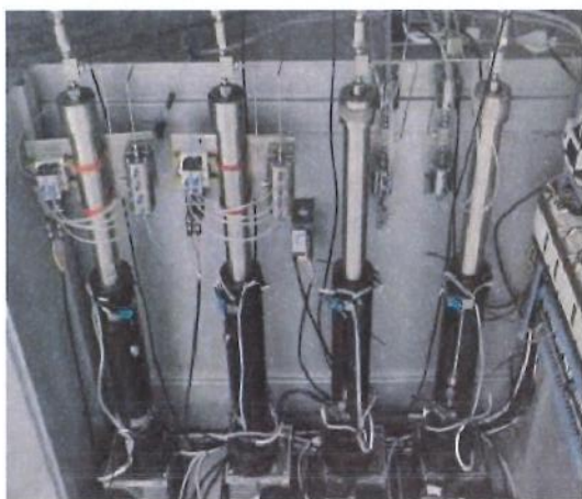
图 2-19 原位 CT 扫描配套装置
