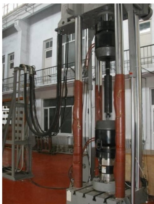
图 15 MTS 公司 2500kN 电液伺服试验机
