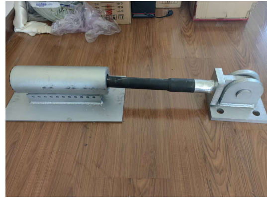
图 8 新型防落梁装置
