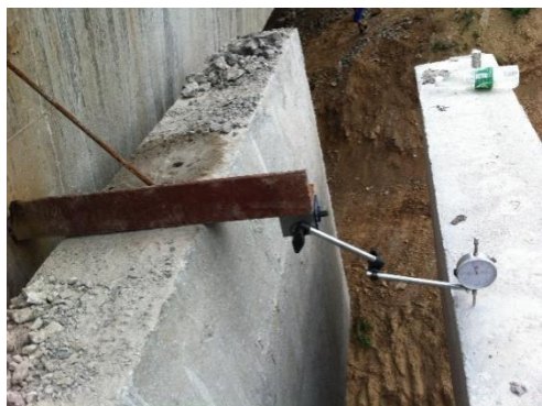
图 7 盖梁上沉降测量仪器布设示意图 图 8 主梁上沉降测量仪器布设示意图
