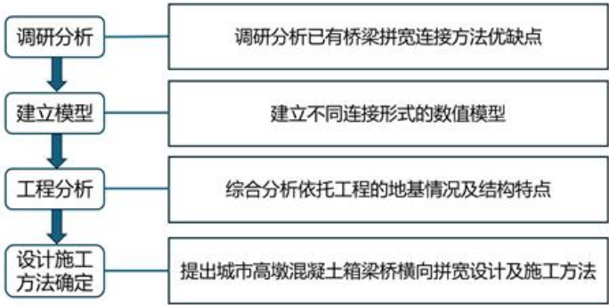
图 24 典型拼宽方式与连接构造研究流程
