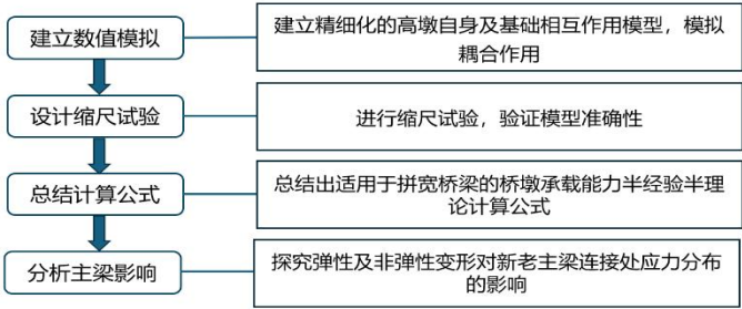
图 28 高墩变形对主梁受力与变形的影响分析流程
