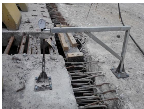
图 7 盖梁上沉降测量仪器布设示意图 图 8 主梁上沉降测量仪器布设示意图
