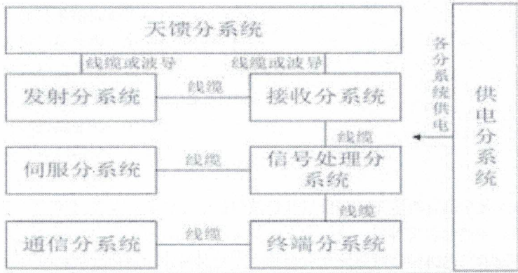
图 3.1 X 波段测雨雷达组成示意图
