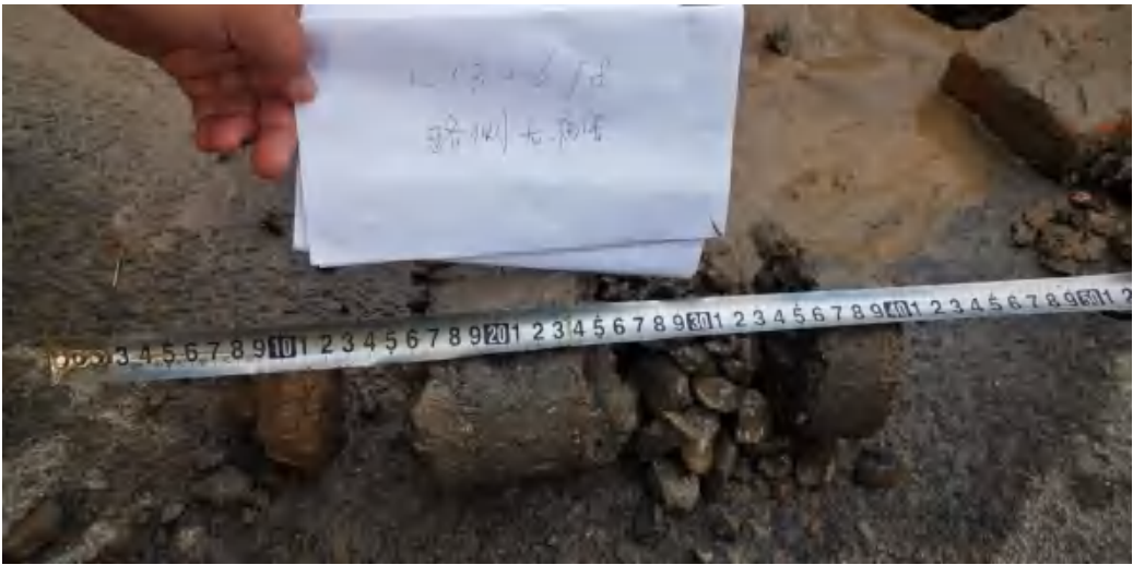
K13+678 左幅车道 路基侧结构完好处
