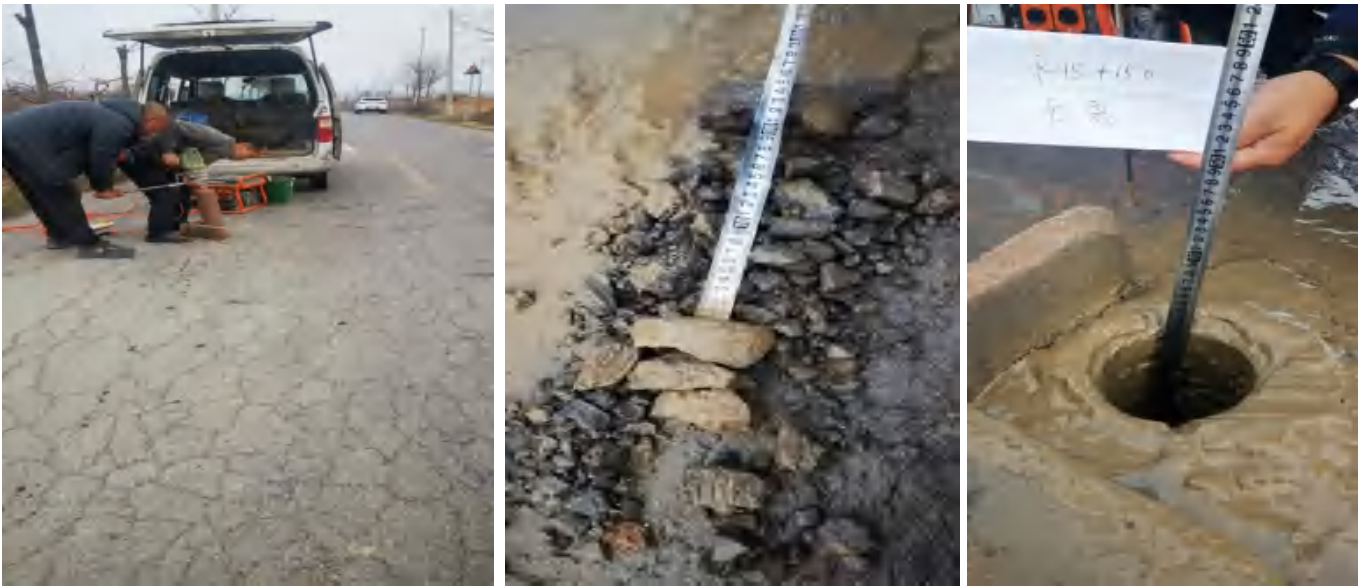
K15+150 右幅车道 路面网裂（龟裂）
