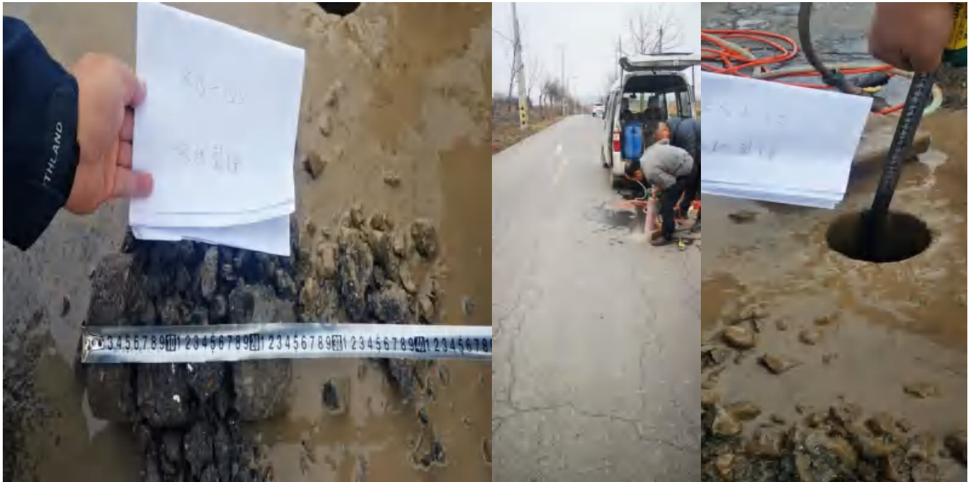
K15+150 左幅车道 路面网裂（块状裂缝）
