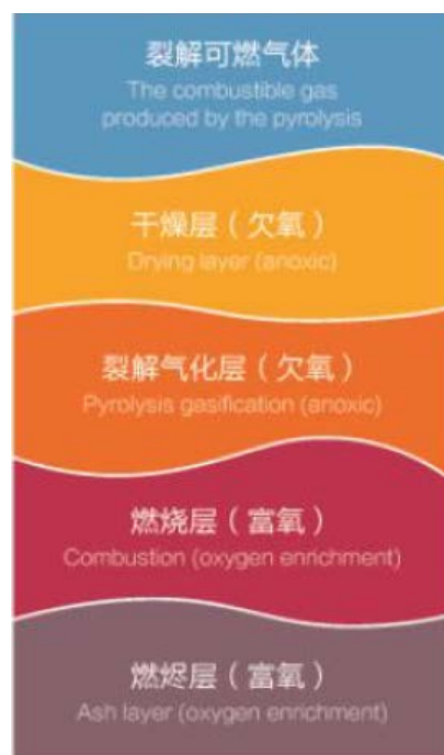
图 5-17 热解气化炉原理图
