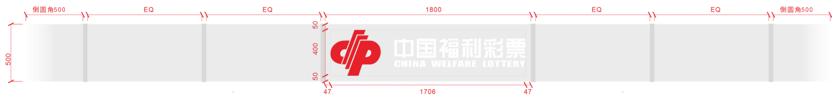
500mm高亚克力板造型门头长度尺寸规范示意图
