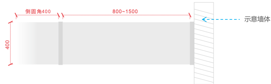
400mm高亚克力板造型门头长度尺寸规范示意图（靠墙放置）
