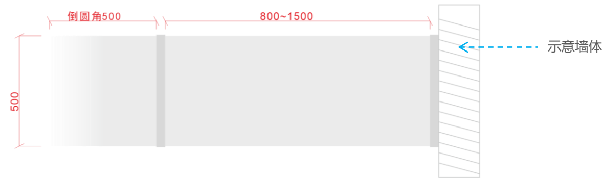
500mm高亚克力板造型门头长度尺寸规范示意图（靠墙放置）
