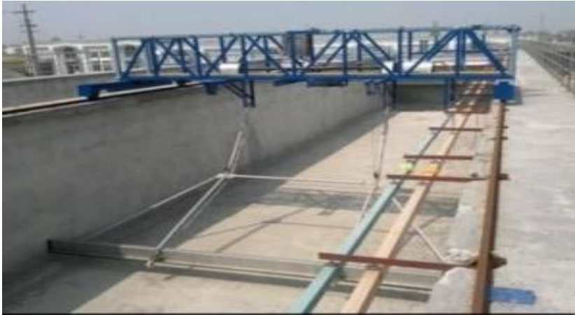
（桁车式提耙刮泥机示意图）
