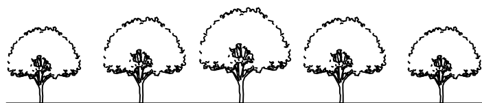
7.2: 种植时若遇到管线等障碍物, 应适当调整间距, 行道树高差不大于0.5m, 且枝下分枝高度高差小于0.5m, 力求栽植后整齐划一。当苗木自然高度不一致时, 应将较高苗木种植在树列中间位置, 使林冠线呈平滑的拱形。
