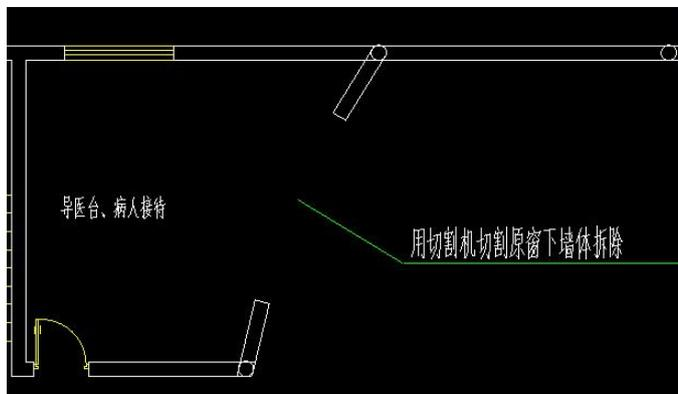
切割墙体高 1100mm, 长 3100mm, 地面贴瓷砖, 墙面瓷砖修补。
