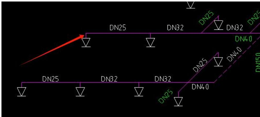
喷头距支管长度约 600mm，在楼层板下 1200mm 吊顶安装。
