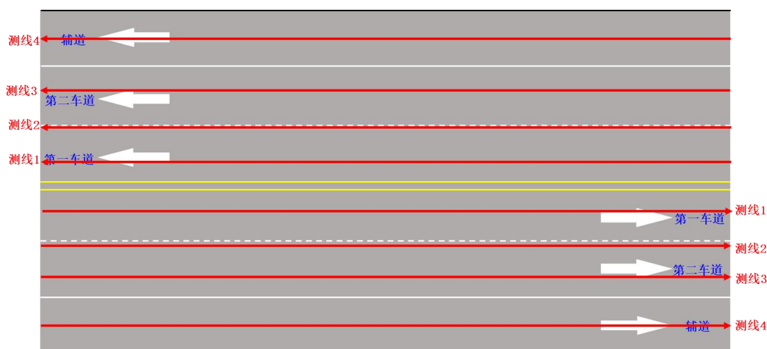
图 6-3 道路上方雷达探测布线图
