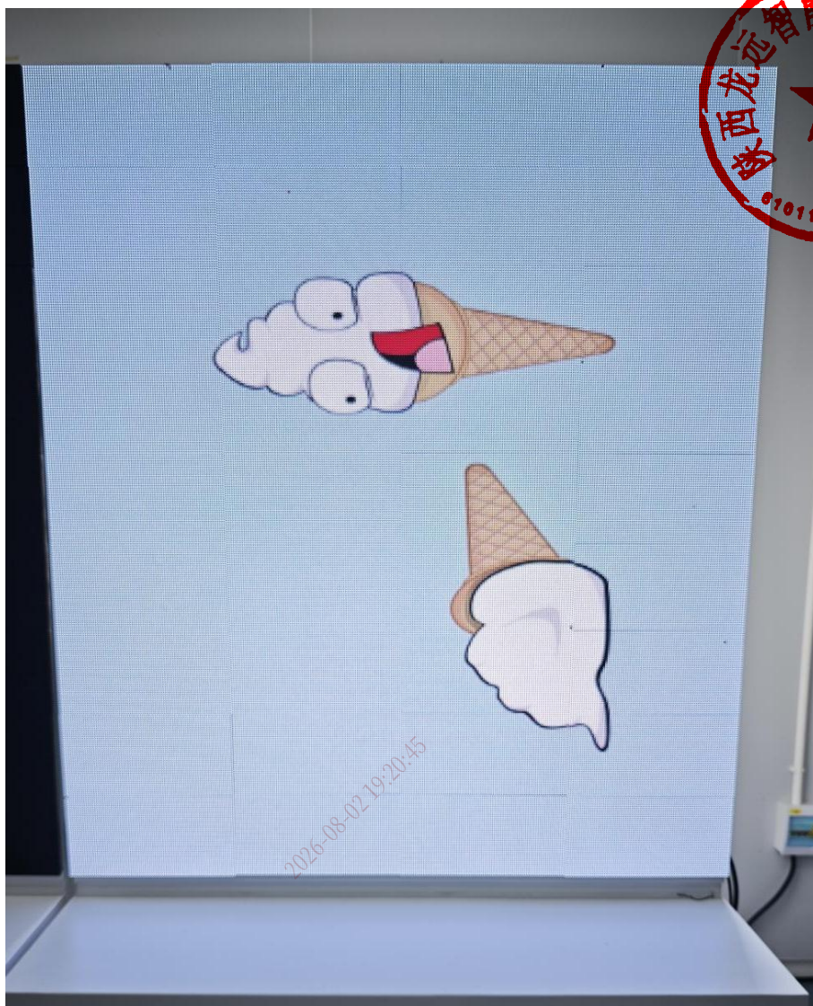
图 47. 实训台画面旋转 180° 的现场实拍图
