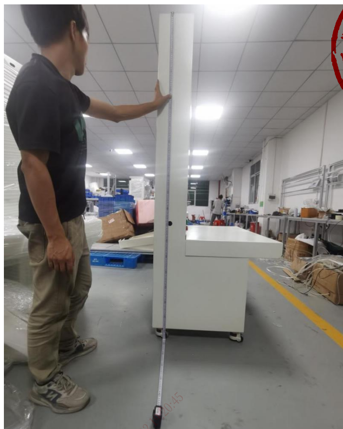
图 31. 安装阶段进行实训台高度测量的实拍图
