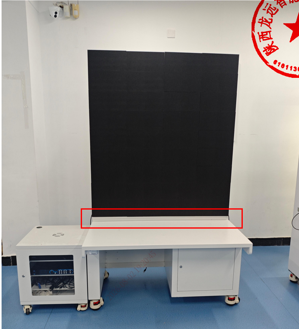
图 40. 红框内为实训台上托扶结构的位置
