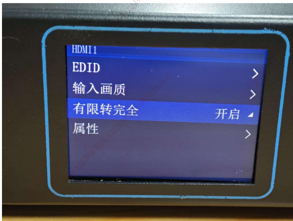
图 9. 通过设备前面板支持有限转完全的功能
