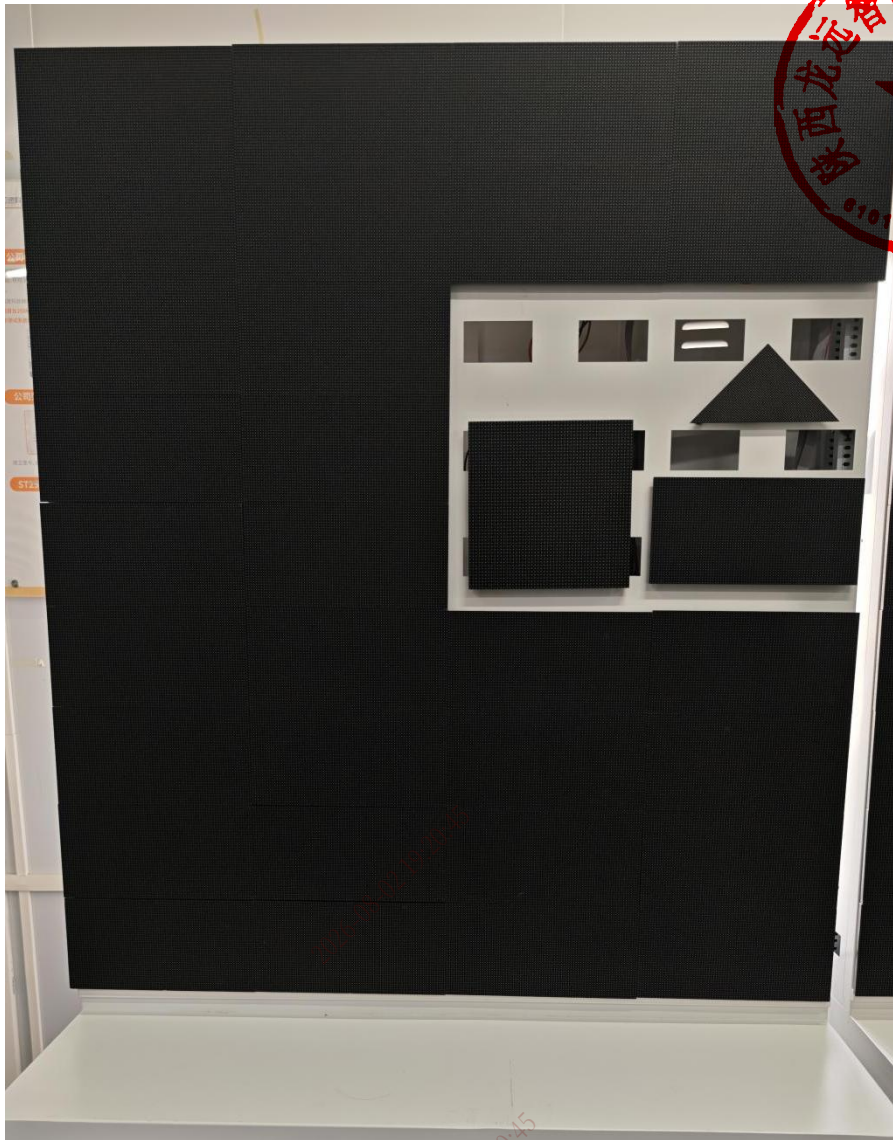
图 36. 实训台同时安装三角形、正方形、长方形单元板的实拍图
