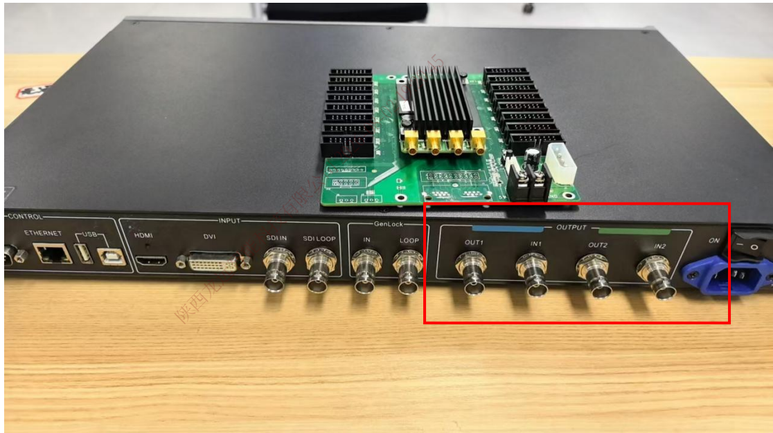
图 7. 图像处理系统的实拍图，红框内为 BNC 接口
