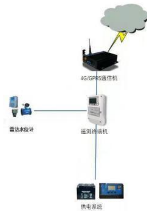
渠道式在线监测设施结构图
