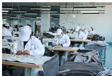
防寒服流水线缝制生产场景
