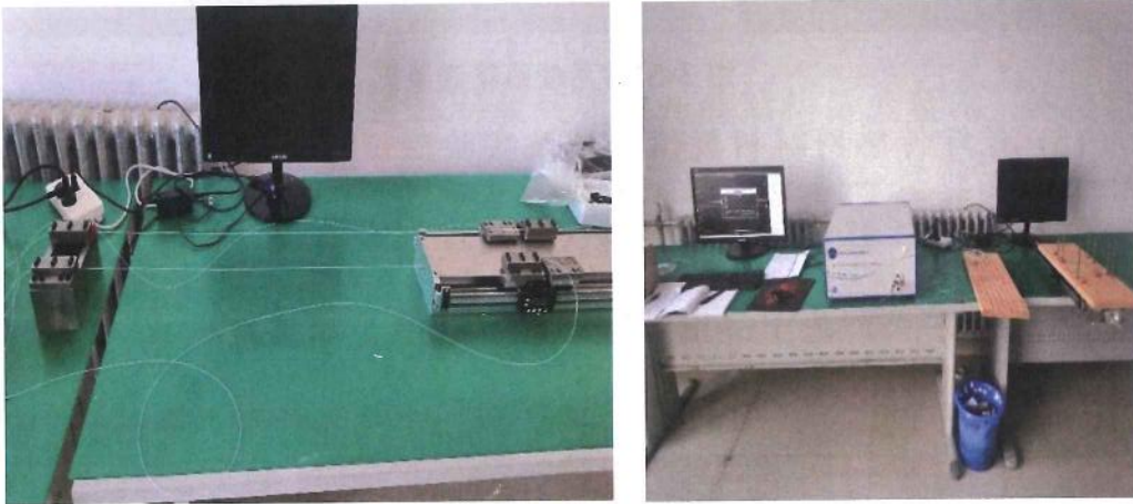
图 3-4 光纤张拉模拟装置及光纤张拉实验
